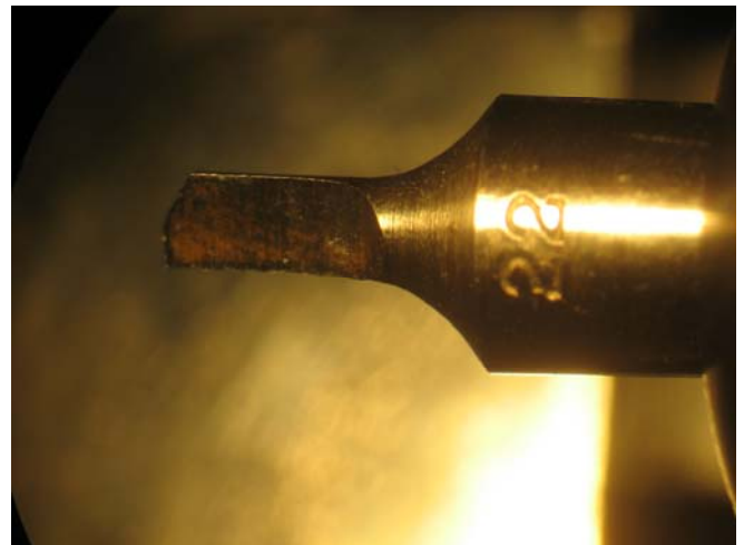
# 11 Här är en D-fräs som är ett tillbehör till urmakarsvarven. D-fräsen är märkt 22, som betyder \text{Ø } 2.2 \text{ mm} . Man kan enkelt tillverka egna D-fräsar.
