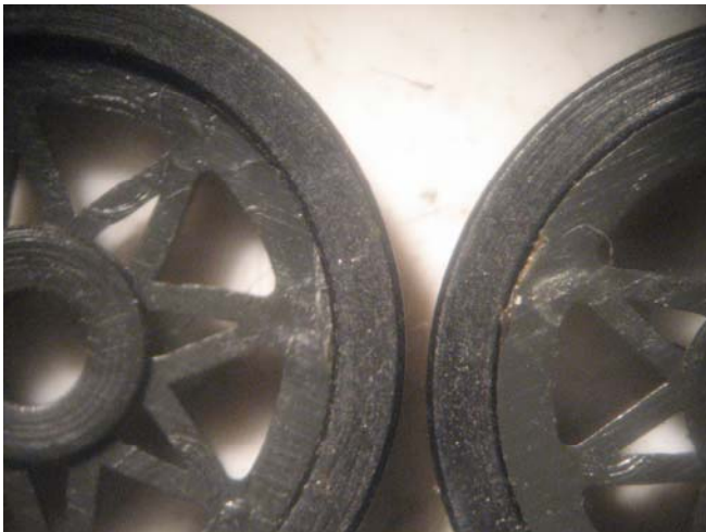
# 2 Här ser man att den högra plastinsatsen inte är helt inpressad i hjulringen, en vanlig orsak till wobbling.
