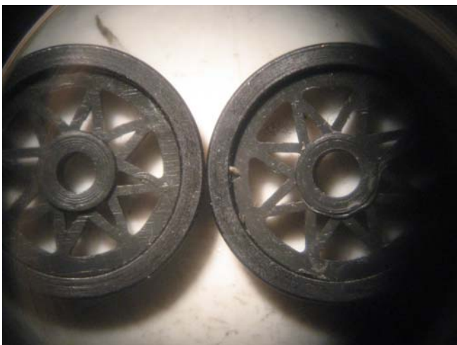
# 14 Högra hjulet är nu fräst till \varnothing 2,2mm, centrerat. Lämpligen så fräser man flera hjul samtidigt.
