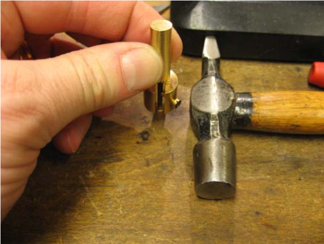
# 25 Pressa på bussningen på hjulaxel, lite slarvigt kan man slå dit bussningen. Risk för att det blir lite snett, så jag rekommenderar någon bättre metod.
