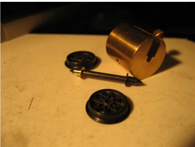
# 27 Axel med två hjulbussningar. Mässing och ABS plastbussning. MRW-Hjultolken användes för att kalibrera back-to-back avståndet 14,43mm.
