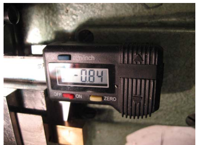
# 18 Svarva ner till \varnothing 2,3mm, 4-2,3=1,7 , hälften på var sida blir tjockleks minskning på 0,85mm. Här syns ett fast monterat skjutmått på min urmakarsvarv, som digital skala. Väldigt praktiskt.
