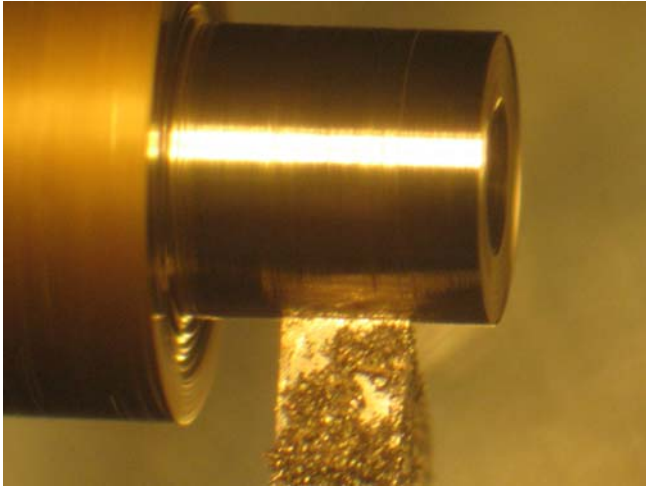
# 19 Mässing istället, svarvat till \text{\O} 2,3mm, samt 2,4mm, 0.1mm längre än måttsättningen, men det är för att snygga till bussningen efter borrar.
